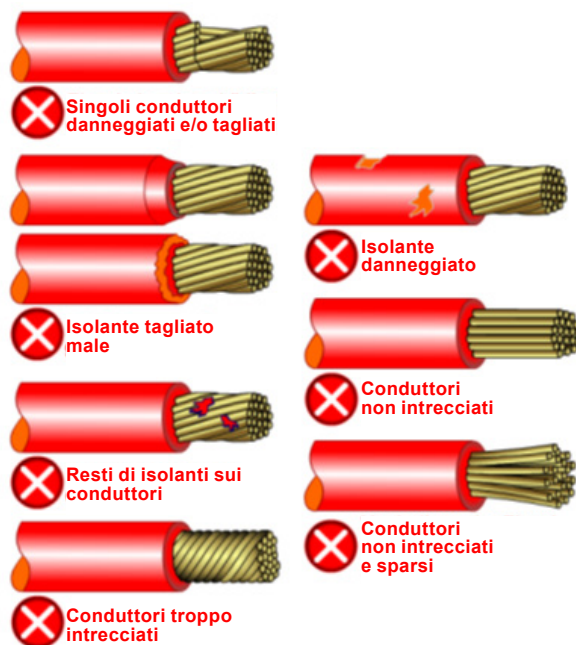
Immagine 2: controllo visivo del cavo di connessione dopo la spellatura, immagine gentilmente messa a disposizione da https://kabelforum.com , Sig. Kratt (traduzione Swissolar)
