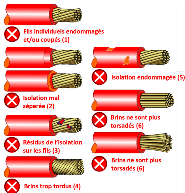
Figure 2: Contrôle visuel des câbles de raccordement après le dénudage. Image : avec l'autorisation aimable de https://kabelforum.com , Herr Kratt
