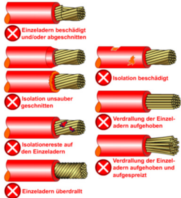
Abbildung 2: Sichtkontrolle Anschlusskabel nach der Abisolierung, Bild: mit freundlicher Genehmigung von https://kabelforum.com , Herr Kratt
