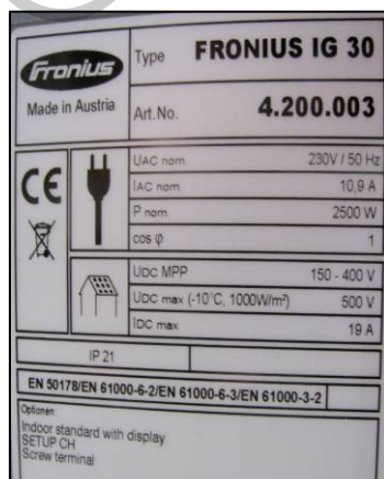
Photo 3 : Plaquette signalétique d'un onduleur
