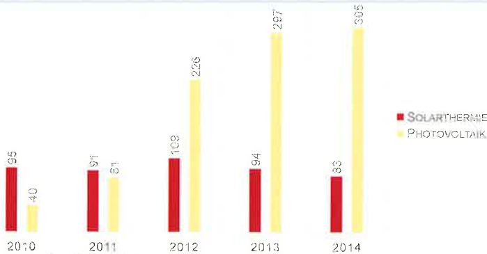
Abb. 1: Neu installierte solarthermische und photovoltaische Leistung in der Schweiz von 2010 bis 2014 in MW
