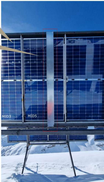
Verschattungskulisse auf Modulrückseite, Testanlage Tschers (144HC Alpin, Portrait) Azimut 0° S, Neigung: 65° (OTF22) Quelle: ewz, ZENDRA, Gantner Instruments
