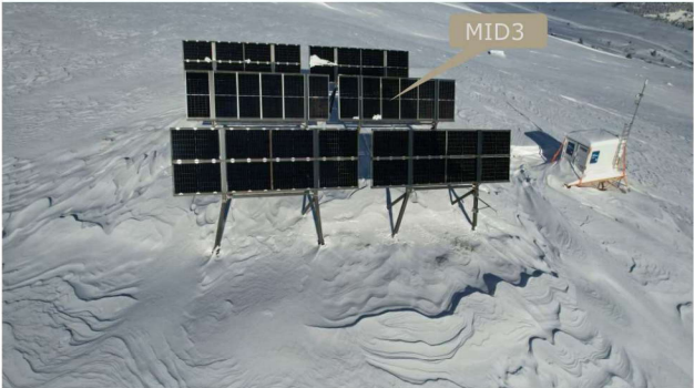
Messplatz mit Solitec SOLID Alpin Prototyp 560Wp (seit 11/2023)
