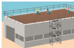
1 Zugang aufs Flachdach über einen Treppenturm aussen am Gebäude
