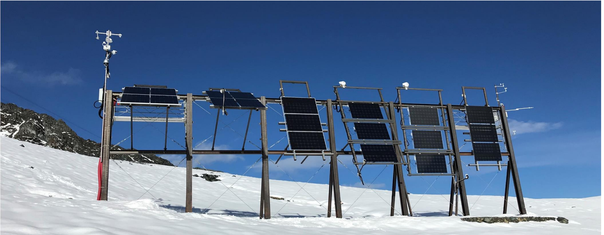
Fig. 1: Vista frontale dell'impianto di prova a 2'400 m.s.m. a Davos. Tutti i moduli sono rivolti a sud. Abb. 1: Ansicht der Versuchsanlage auf 2400 m.ü.M. in Davos von vorne. Alle Module sind gegen Süden ausgerichtet.
