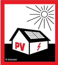
Questa targhetta di segnalazione deve essere applicata presso l'interruttore di sovracorrente generale e presso l'apparecchiatura assiemata di manovra tra l'interruttore di sovracorrente generale e l'inverter o gli inverter. Essa va apposta in modo ben visibile all'esterno dell'apparecchiatura assiemata di manovra.
