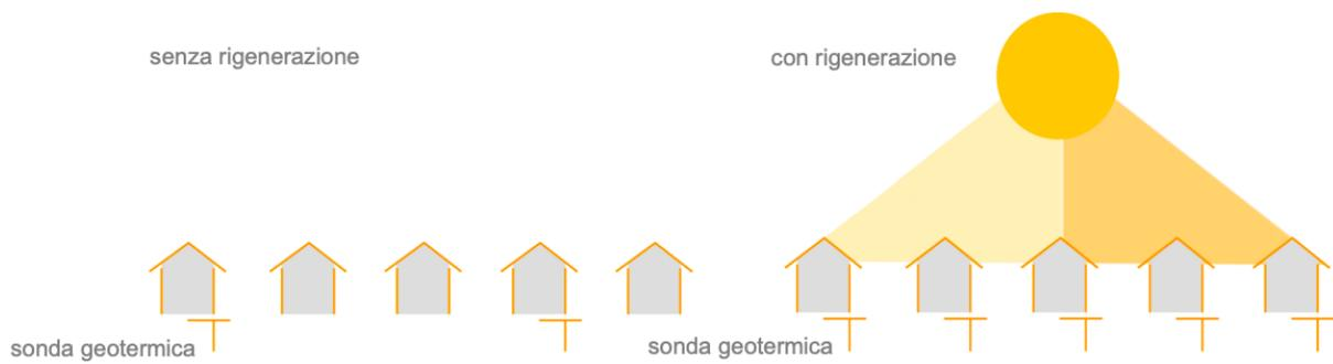
*Fig.3: Il solare termico viene utilizzato per rigenerare attivamente il terreno, il che significa che il potenziale delle efficienti pompe di calore geotermiche può essere sfruttato meglio.*
