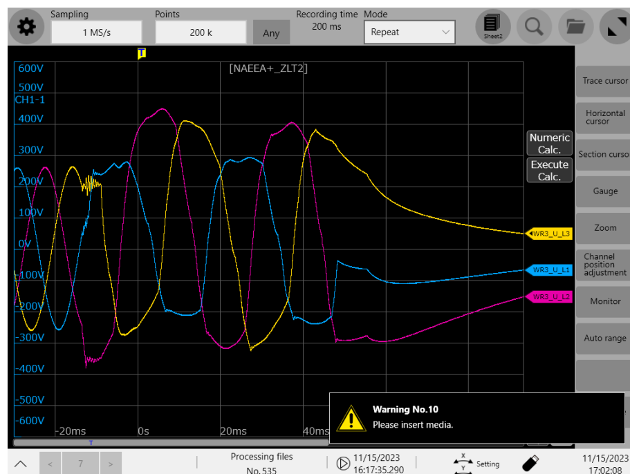
Abbildung 5.2-15: Oszilloskop-Aufnahme der Ausgangsspannungen von Wechselrichter 2 nach der Trennung vom Netz durch den externen NA-Schutz
