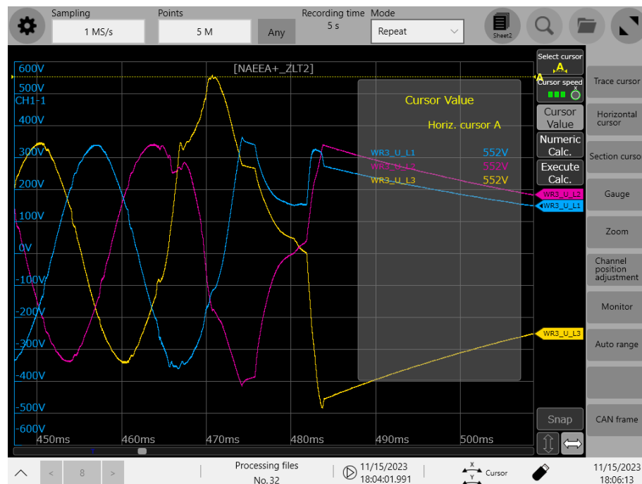
Abbildung 5.2-19: Oszilloskop-Aufnahme der drei EEA-Seitigen Phasenspannungen gegenüber dem Neutralleiter.
