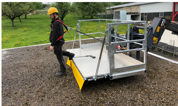
Figura 31: Piattaforma aerea di lavoro con possibilità di assicurazione. Fonte: Jakob Fahrzeugbau AG
