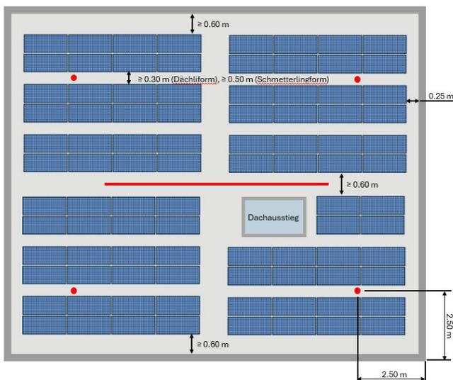
Abbildung 14: Seilsicherung (Ausstattungsstufe 2) mit EAP (Ausstattungsstufe 1) im Eckbereich, Quelle: Gebäudehülle Schweiz
