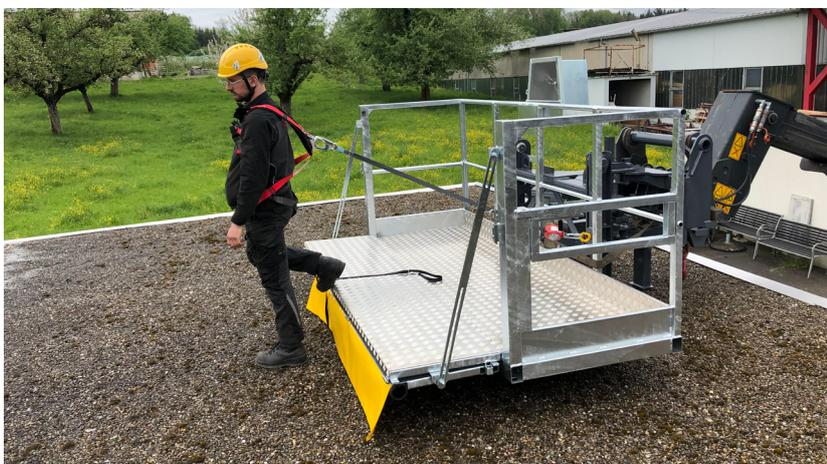
Abbildung 31: Hubarbeitsbühne mit Sicherungsmöglichkeit, Quelle: Jakob Fahrzeugbau AG
