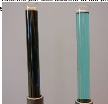
Figure 2: Caloporteur à l'état neuf (à droite) et à la suite d'une surcharge thermique (Source : Soltop)
