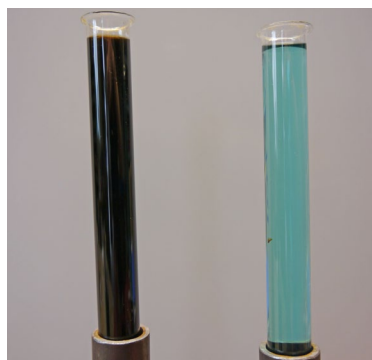
Figura 2: I fluidi di trasporto termico, quando sono nuovi (a destra) e in seguito ad un sovraccarico termico (Fonte Soltop)
