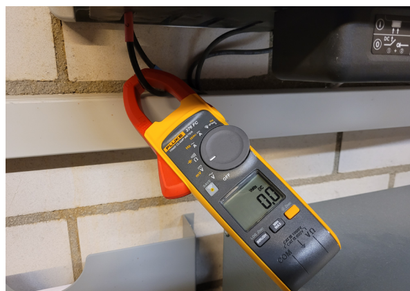
Figura 3: Misurare (verificare) l'assenza di corrente, Swissolar
