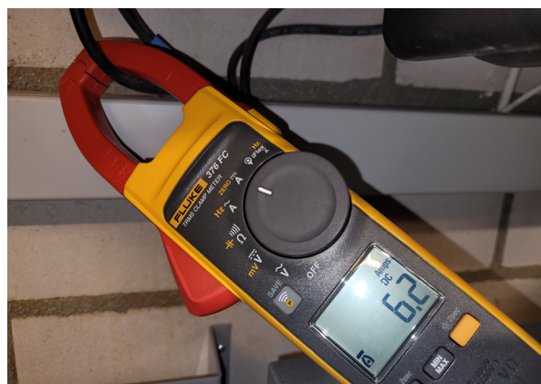
Figura 2: Verifica funzionalità dello strumento di misura, Swissolar
