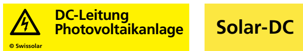
Abb. 4: Kennzeichnungen von DC-Leitungen, DC-Klemmkasten und dgl. (DC Betriebsmittel, welche auch bei abgeschalteter Anlage unter Spannung stehen) (gemäss NIN 2020)
