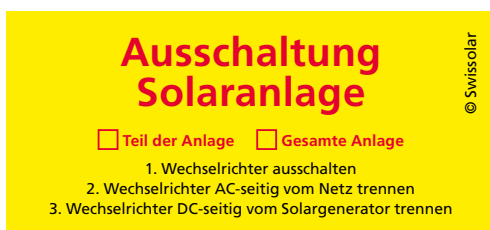
Abb. 7: Anbringung am Wechselrichter oder beim Anlageschalter
