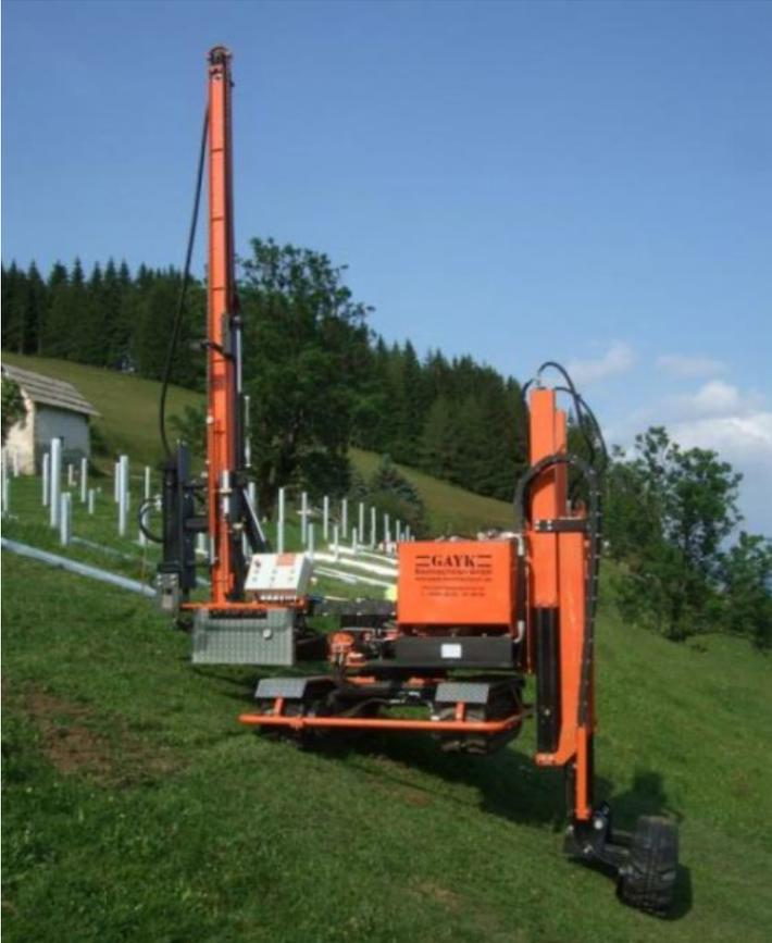
Abbildung 17: Maschine für das Rammen von Profilen. © R&L Co., Ltd. <http://www.rlsolar.jp> (April 2024)
