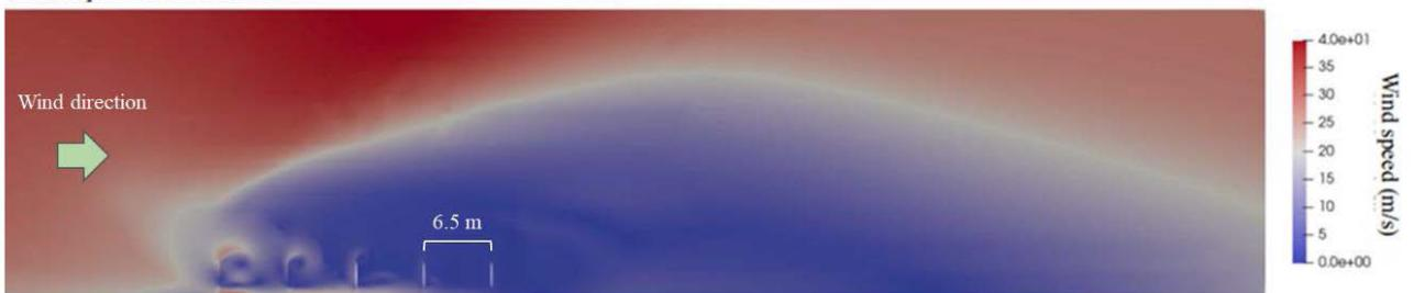
Abbildung 5 Druckverteilung und Windgeschwindigkeit für vertikal aufgeständerte PV-Module.
