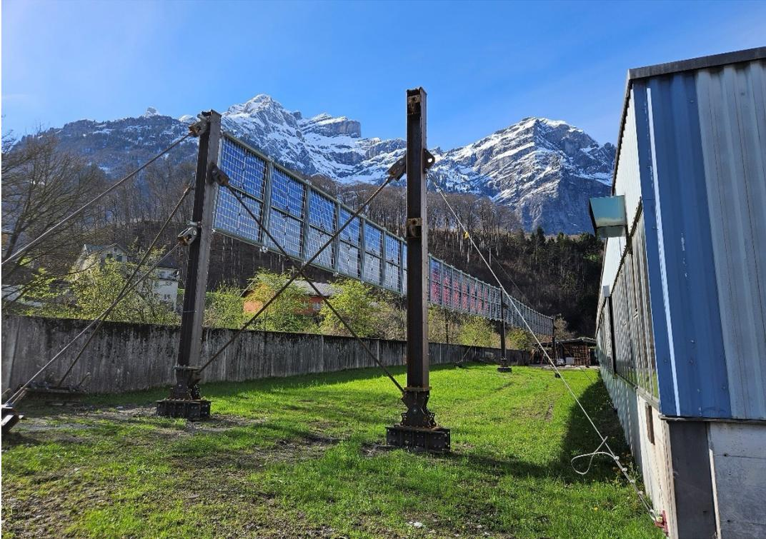
Abbildung 21: Demonstrationsanlage des Kompaktsolareseil-Systems auf dem Firmengelände der Inauen-Schätti AG.
