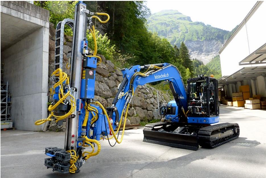
Abbildung 18: Bohrbagger Morath BB7000-7FP zur Mikropfählerstellung. © Gasser Felstechnik AG (April 2024)
