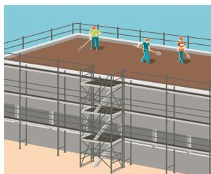
1 Tetto piano con ponte da lattoniere
