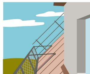
4 Parete di ritenuta sul tetto fissa e protezione lato frontone su un tetto esistente
