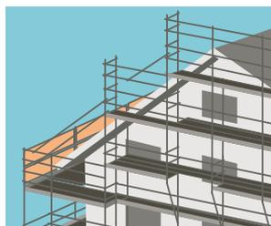
3 Tetto spiovente con ponte da lattoniere e protezione sul lato frontone
