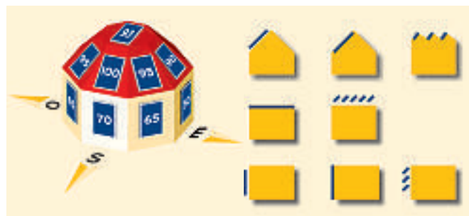
Pourcentage de production optimale pour différentes orientations des capteurs (à gauche) et systèmes de montage.
