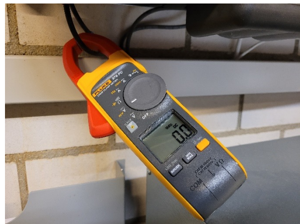
Figure 3 : Mesurer l'absence de courant, Swissolar
