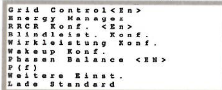
Bild 5 – Überblick WR-Menü Leistungssteuerung
