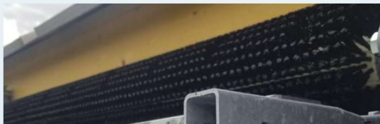
Integrierte Reinigung mit Bürste der PV Module
