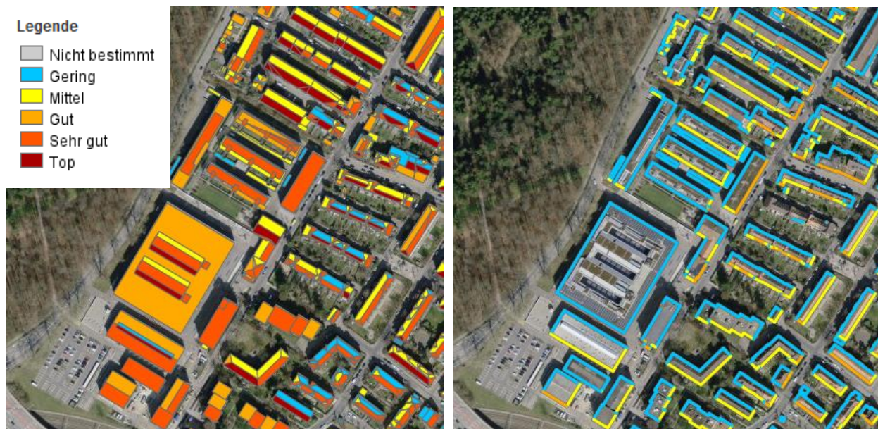
Abbildung 1: Ausschnitt aus Sonnendach.ch; links: Dachflächen, rechts: Fassaden
