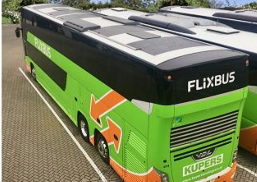
Abbildung 47: Flixbus mit Solarmodulen auf dem Dach, Bild: Flixbus
