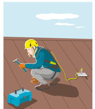
Regel 8 Anseilschutz korrekt einsetzen.
