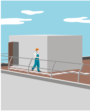
Regel 1 Sichere Zugänge erstellen.
